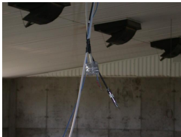
Figure C5.3. Tube d'échantillonnage, filtre, sonde d'humidité et température
