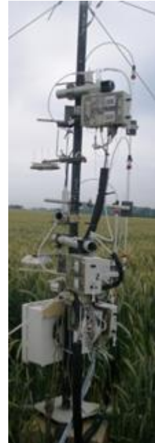
Figure M28.1. Gauche : Schéma illustrant la mesure d'un gradient de NO, NO 2 et O 3 à trois niveaux à l'aide d'une pompe principale, d'électrovannes de dérivation et d'analyseurs de gaz (Stella et al. , 2012). Droite : Photo montrant un dispositif de mesure du gradient d'NH 3 à l'aide d'un analyseur à flux continu multi-canaux équipé de denuders liquides (ROSAA) (Loubet et al. , 2012)
